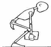
**b** - ampliare la base di appoggio, e quindi le condizioni di equilibrio, allargando e flettendo le gambe, in senso trasversale o longitudinale a seconda della direzione dello spostamento.
